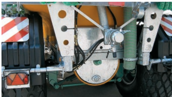
Das Schleuderrad (Turbine) ist in einer Vertiefung des keilförmigen Kunststoffbehälters angebracht. Dadurch kann er vollständig entleert werden.
