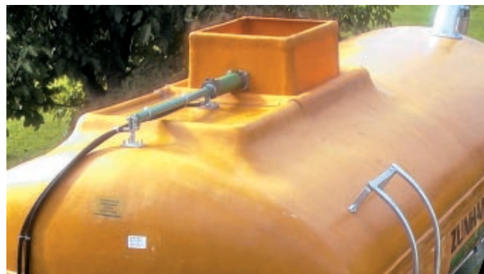
Für die Befüllung von oben ist ein grosser Einfüllschieber mit Spritzschutz wichtig. Möglich sind auch Einfülltrichter.
