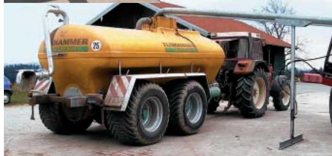
Schleuderfässer werden fremdbefüllt, entweder mit einer festen Leitung von oben oder über einen herkömmlichen Schlauch unten (kleines Bild).
