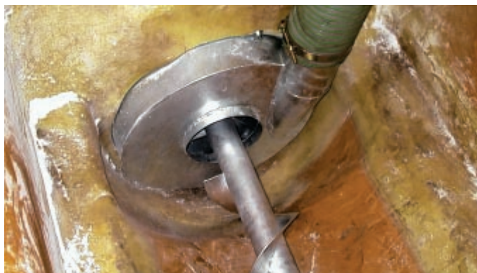
Die früher offenen Schleuderräder sind heute gekapselt und arbeiten wie eine Kreiselpumpe. Sie werden von der Rührwelle angetrieben.
