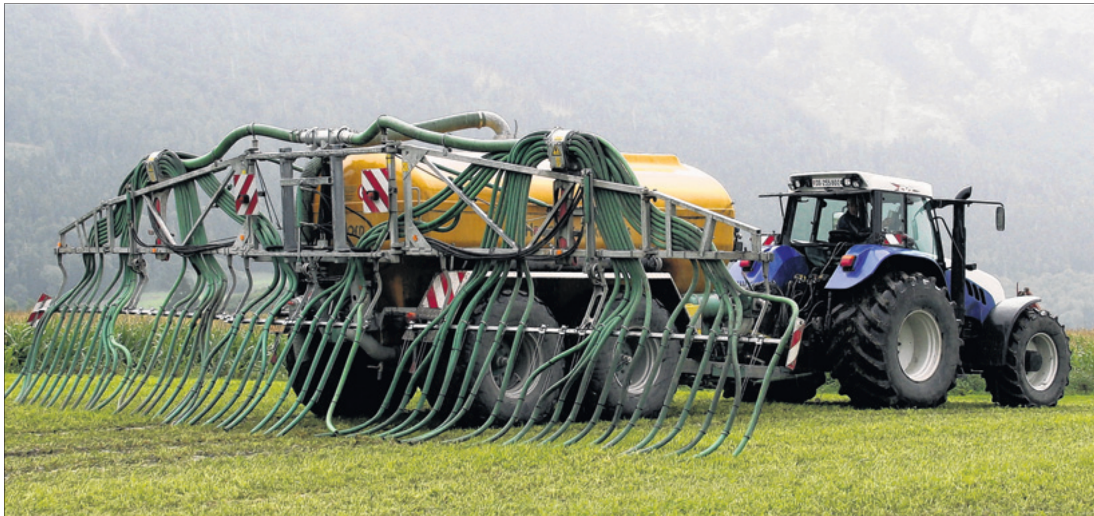
Dieses Güllefass mit einem aufgebauten Schleppschlauchverteiler hat einen Inhalt von 12,5 m 3 . Weil mit dem Traktor doch ein beachtliches Gewicht unterwegs ist, wurde auf diesem Fass eine Reifendruckregulierungsanlage montiert. Wichtig ist ein leistungsfähiger Kompressor, der nach kurzen Leerfahrten den notwendigen Reifendruck für die volle Ladung wieder herstellt. (Bilder Ruedi Hunger)
