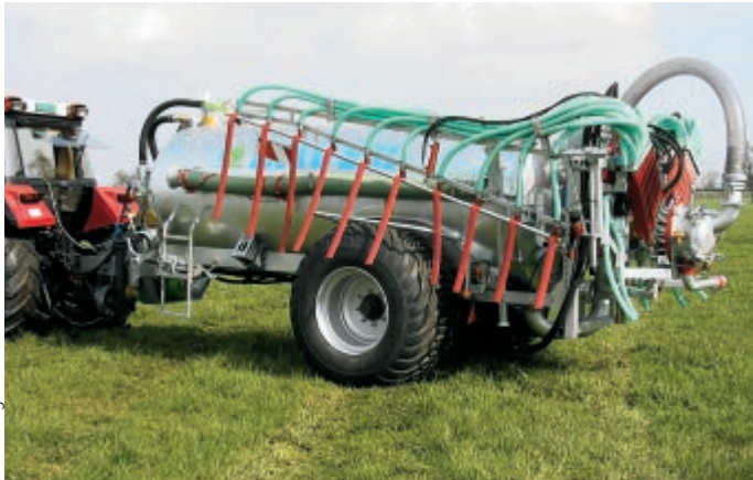
Dieser Verteiler von Schweizer ist mit einem leichten Tropfstopp ausgerüstet, der die flexiblen Schläuche abknickt, jedoch nicht nach oben biegt.
