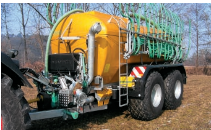
Die Firma Hadorns Gülletechnik baut Schleppschlauchverteiler bewusst nicht auf Vakuumfässern auf, sondern konzentriert sich auf Pumpfässer.
