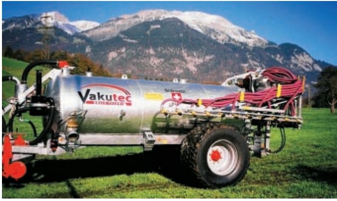
Bei diesem Fass ist die Achse weit hinten, nahe am Verteiler angebracht. Es bleibt genug Stützlast. Die Schläuche werden aufgerollt (Kohli).
