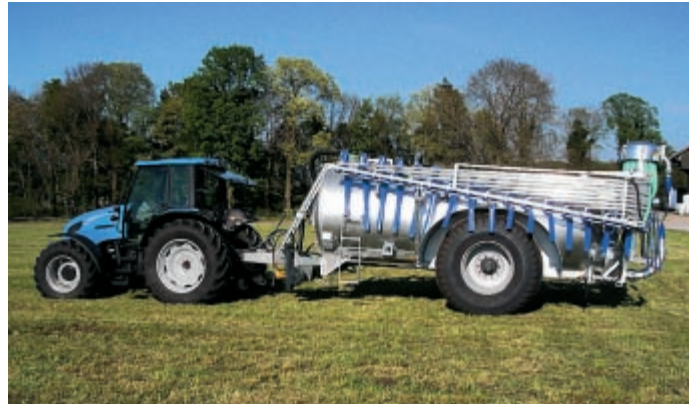
Bei diesem langen Fass entlastet der Verteiler (RAB, Brunner) die Deichsel relativ stark, weil er sich weit weg von der Achse befindet.
