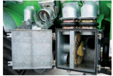
Verdrängerpumpen können mit Fremdkörper-schutz und Schneidwerk geschont werden.
