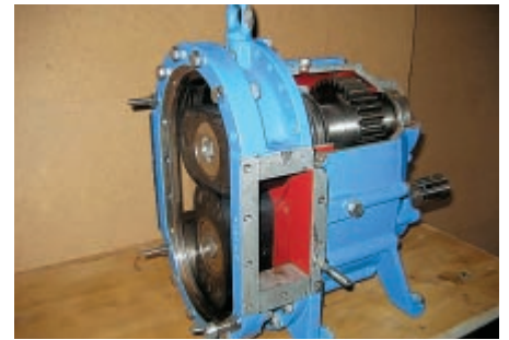
Die Reibung der Gummirotoren der Drehkolbenpumpe hat einen hohen Verschleiss zur Folge.
