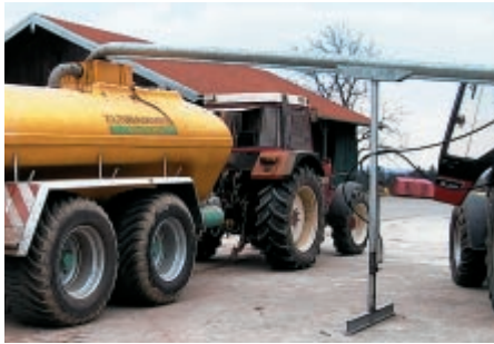
Mit einer Fremdbefüllungseinrichtung kann ein leicht gebautes Schleuderfass eingesetzt werden.
