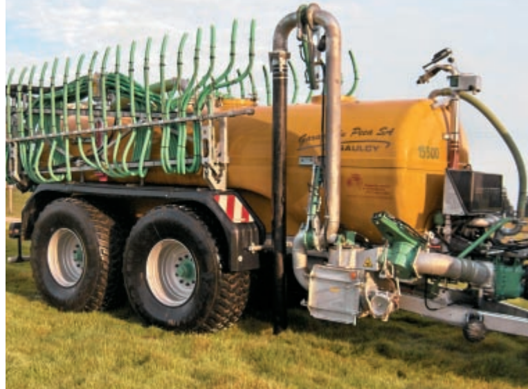
Dieses Hadorn-Fäss ist mit Verdrängerpumpe, Saugrüssel und Fremdkörperschutz mit Schneidwerk ausgerüstet.
