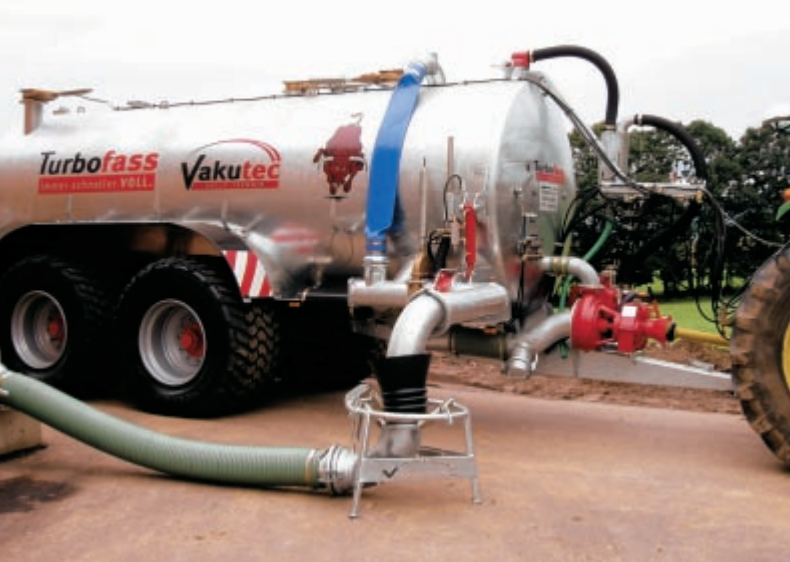
Das Turbofäss ist mit einer Zentrifugalpumpe und einer Vakuumpumpe ausgerüstet. Dieses Modell verfügt über einen Rücklauf bei vollem Fass.
