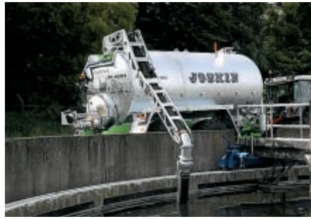
Neben dem Pumparm kann auch ein reiner Saugrüssel am Fass angebaut werden.
