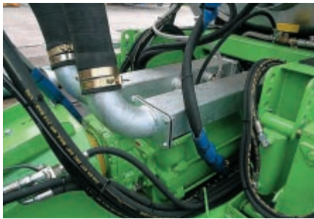
Die Wasserring-Vakuumpumpe ermöglicht einen höheren Unterdruck.
