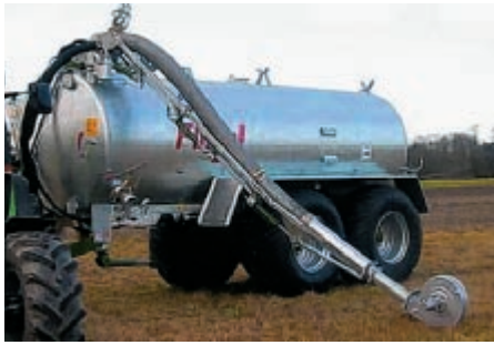
Ein Pumparm mit hydraulischer Kreiselpumpe ist komfortabel, aber schwer und teuer.
