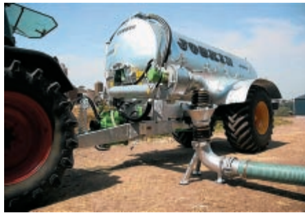
Dieses Vakuumfass ist mit hydraulischer Füllhilfe und einem Docker ausgestattet.
