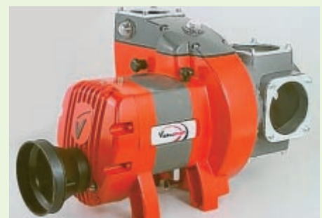
(beide Bilder rechts). Bei dieser Pumpe ist der Zentrifugalpumpe eine Flüssigkeitsringpumpe vorgeschaltet. Diese bleibt nach dem Abschalten mit Flüssigkeit gefüllt und sorgt dafür, dass beim erneuten Pumpenstart eine Saugwirkung entsteht. Diese Pumpe ist jedoch nicht für alle Arten von Gülle geeignet (siehe Interview Seite 24).
