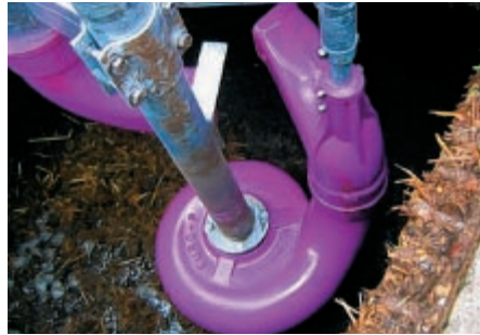
Die mobile Rühr- und Spülpumpe kann als Hochleistungsfüllstation eingesetzt werden.
